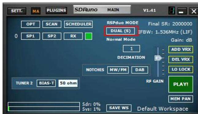
Grâce à la fonction de mise en page automatique (bouton OPT), il est désormais possible que les deux instances de SDRuno remplissent l'écran de manière optimale :
