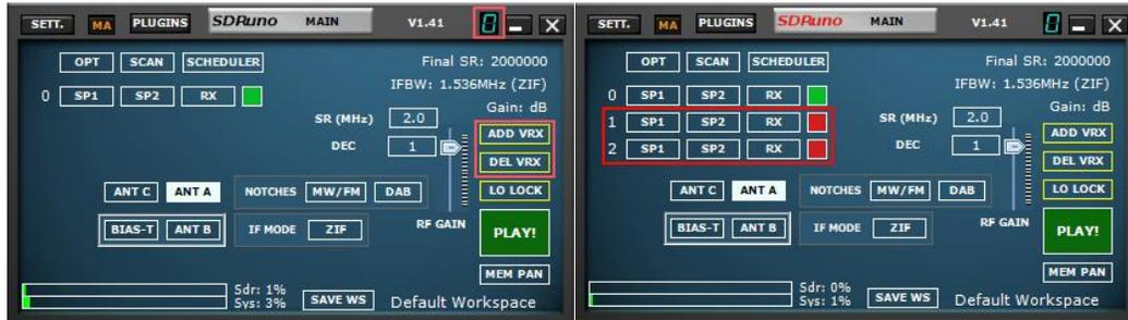
**AJOUTER VRX** – Cela vous permet d'ajouter un VRX supplémentaire, cela ne peut être ajouté que si le RSP est arrêté. Le VRX supplémentaire doit se trouver dans la bande passante sélectionnée que vous avez sélectionnée (SR MHz).
