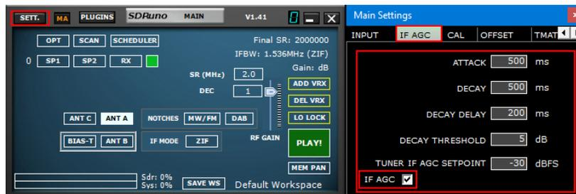
SDRuno 1.3 a vu l'introduction d'une API mise à jour avec un schéma IF AGC amélioré. Cela a plus de configuration et vous permet de mieux conditionner l'IF AGC à leur environnement de signal. D'autres améliorations pour mieux aligner le changement de gain avec le bon point dans le flux IQ ont également contribué à supprimer l'effet de rebond observé dans les versions précédentes.
