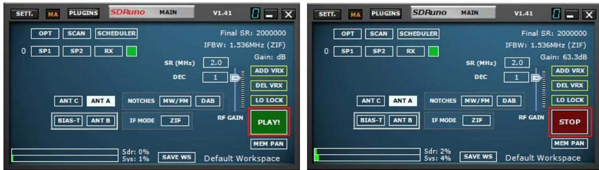
Le démarrage du RSP dans SDRuno se fait en cliquant sur le bouton vert PLAY affiché dans le panneau PRINCIPAL. Le bouton PLAY deviendra rouge et réétiqueté en STOP. Cliquez sur le bouton STOP pour arrêter le flux SDRuno. Cliquez sur le X en haut à droite pour fermer l'application SDRuno. SDRuno peut également démarrer automatiquement le flux en sélectionnant « Démarrage automatique activé » dans les paramètres OPT du panneau PRINCIPAL.
