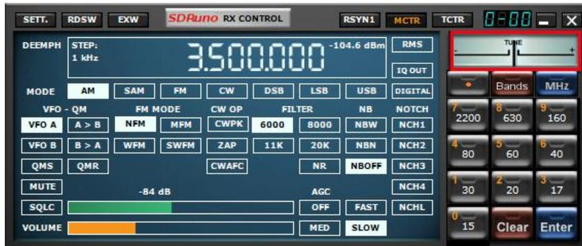
Lorsqu'il est utilisé avec n'importe quel RSP, le S-Mètre est calibré avec précision. Pour passer de la fonction S-Mètre au réglage FM et vice versa, cliquez simplement dessus. Par défaut, les paramètres de la région IARU 1 sont utilisés. Dans ce mode, S9 = -73 dBm pour les fréquences jusqu'à 30 MHz et S9 = -93 dBm pour les fréquences supérieures à 30 MHz. Ce paramètre peut être modifié dans le menu Paramètres du panneau principal.
