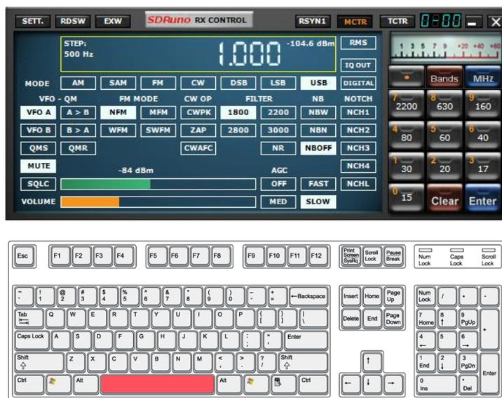
Si vous souhaitez utiliser le clavier, l'un des panneaux VRX doit être sélectionné. Pour saisir une fréquence directement avec le clavier et/ou la souris :
