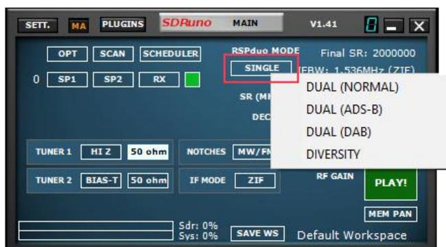
DUAL (NORMAL) - Sélectionnez ce mode, sauf si vous avez l'intention d'exécuter ADS-B à l'aide du tuner esclave
