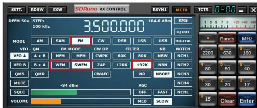
La démodulation/décodage RDS fonctionne en modes WFM et SWFM. Il existe deux modes de fonctionnement pour le système RDS : OFF et Mode1 . Vous pouvez sélectionner un mode spécifique pour un VRX dans la fenêtre RX Control->SETT.->RDS.
