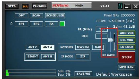
Le curseur RF GAIN doit être placé au maximum ou aussi près que possible du maximum, sauf si un message d'avertissement OVERLOAD s'affiche. Si un message OVERLOAD s'affiche, abaissez le curseur RF GAIN jusqu'à ce que le message OVERLOAD ne s'affiche plus.
