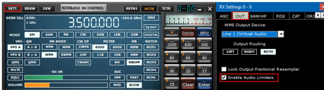
Le système audio SDRUno est optimisé pour la meilleure qualité sonore. Cela implémente plusieurs filtres et limiteurs dans le chemin audio. Si des mesures du chemin audio sont nécessaires, les filtres et les limiteurs peuvent être désactivés en décochant cette option. Des précautions seront nécessaires car le niveau audio n'est plus limité; cependant, des mesures peuvent maintenant être effectuées à la sortie audio.
