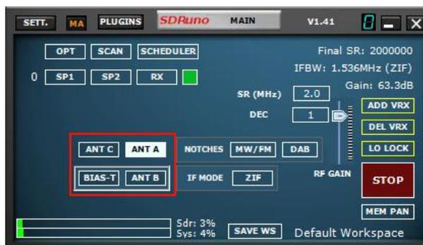
Selon le modèle RSP (2/2pro, duo & dx), vous pouvez sélectionner différentes entrées pour cet appareil. Assurez-vous que l'entrée correcte est sélectionnée dans le panneau PRINCIPAL et que votre coaxial est terminé à cette entrée sur l'appareil. Les RSP1 et RSP1A ont une seule entrée, de sorte qu'aucun bouton de sélection d'entrée n'apparaîtra.
