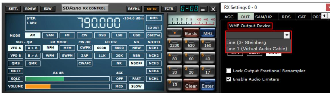
Chaque VRX peut avoir son périphérique de sortie WME. Plus de VRX peuvent partager le même périphérique WME. Le périphérique de sortie peut être sélectionné dans l'onglet Contrôle->Réglages->Out RX. Si aucun périphérique n'est sélectionné (par défaut), le VRX utilisera la valeur par défaut du système (mappeur de son). SDRuno doit avoir un périphérique de sortie. Pour plus de détails sur les récepteurs virtuels (VRX), reportez-vous à la section [4.12](#)
