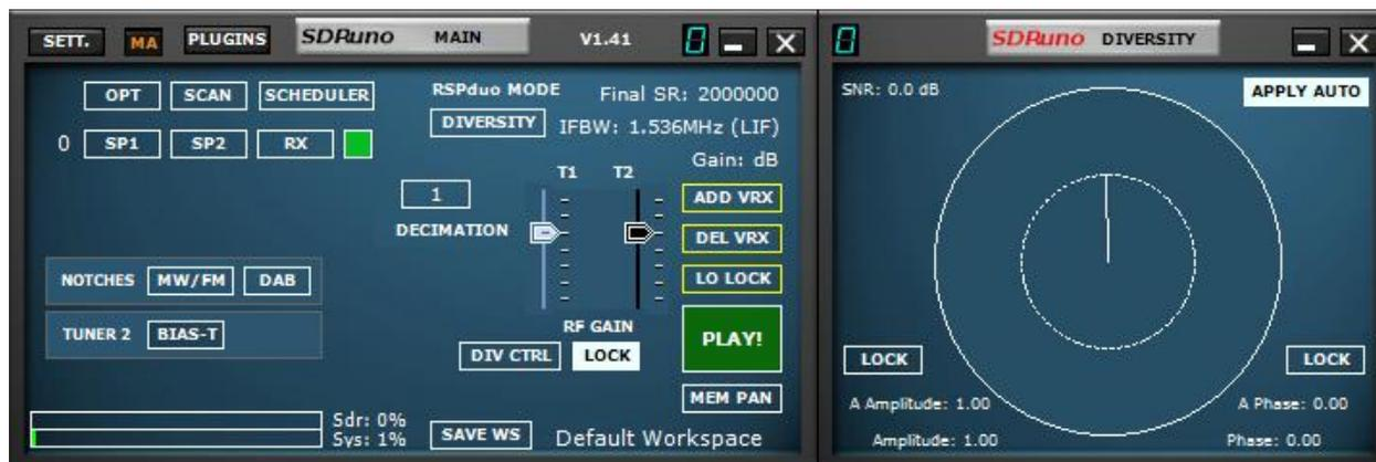
Le mode automatique peut être désactivé en appuyant sur le bouton APPLIQUER AUTO, puis avec le bouton gauche de la souris enfoncé, sélectionnez une phase (indiquée par l'angle dans le cercle) et une amplitude (indiquée par la longueur de la ligne à appliquer aux flux IQ entrants). Les commandes de phase et d'amplitude peuvent également être verrouillées indépendamment afin de permettre un contrôle manuel plus fin.
