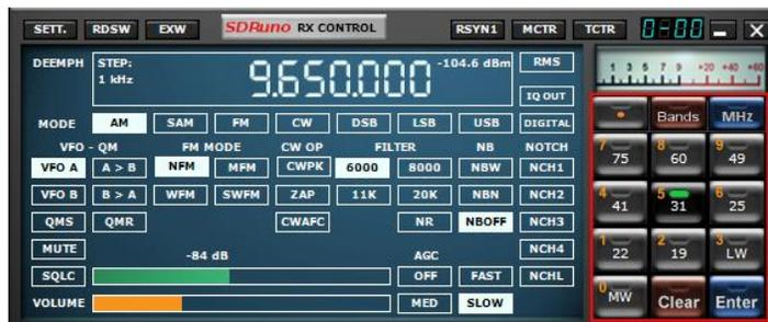
Lorsque vous appuyez sur l'un des boutons de cadrage de bande dans le panneau RX CONTROL, le bouton de bande sélectionné s'allume en vert, ce qui permet de verrouiller le LO, le réglage automatique de la fréquence d'échantillonnage et de la valeur de décimation ainsi que le mode RX correct pour la bande sélectionnée. Le panneau MAIN SP va maintenant « cadrer » la gamme de fréquences complète de la bande choisie.
