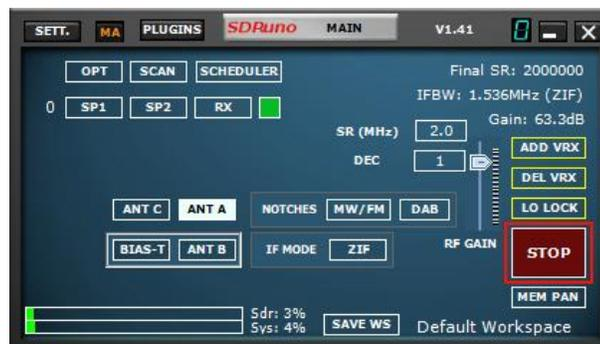
Cliquez sur le bouton STOP sur le panneau MAIN pour arrêter le flux de données (mise hors tension).
