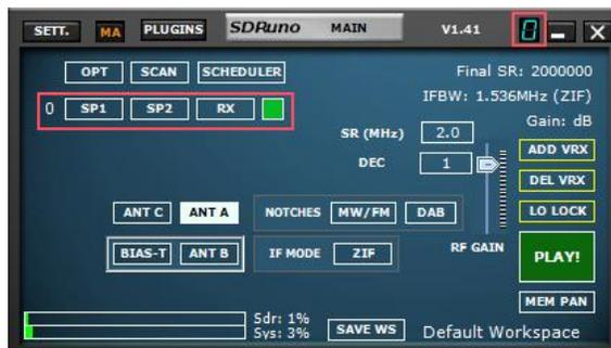
SDRuno peut créer et exécuter plusieurs VRX dans la même instance d'application. Lorsque vous exécutez une instance de SDRplay, un seul VRX est toujours créé : il s'agit du VRX « maître » ou VRX #0. VRX #0 a quelques particularités:
