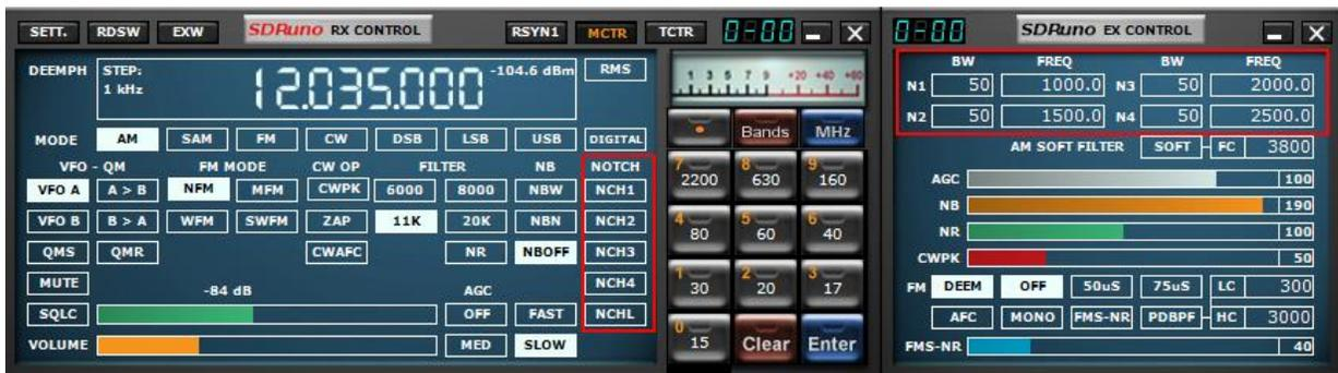
Chaque VRX offre quatre filtres à encoche pour supprimer les signaux indésirables, placés avant l'AGC audio. Chaque filtre d'encoche peut être activé/désactivé par le bouton correspondant dans le panneau de configuration RX. Les paramètres de bande passante et de fréquence des filtres à encoche sont disponibles dans le panneau de commande RX EX. Pour les filtres à encoche 1 & 2, les fréquences peuvent être rapidement réglées « à la volée » comme suit :
